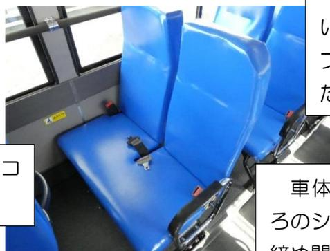
車体と同じ濃いみずいろのシートです。ベルトの締め間違いを防ぐため、ベルトは黒とグレーに色分けされています。
